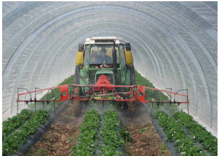
Erdbeerdoppelreihen-Applikation im Tunnel
